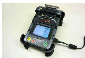
FITEL S123 を用いて光ファイバの融着を行います
